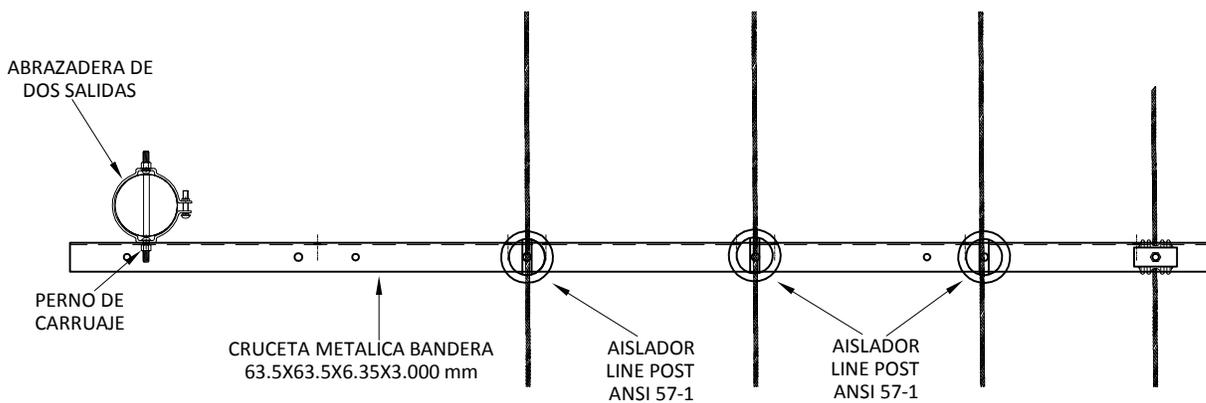
ES DE USO EXCLUSIVO CON LA RED DE BT MONTADA AL EXTREMO DE LA CRUCETA, VER NORMAS BT 07-BT 08 VANO MAX. 40 mt.
