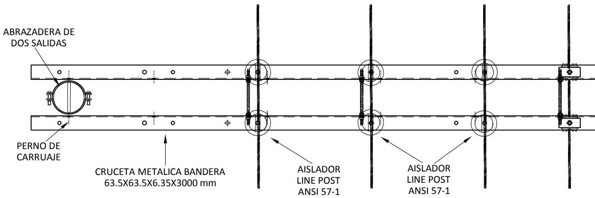
**ES DE USO EXCUSIVO CON LA RED DE BT MONTADA AL EXTREMO DE LA CRUCETA, VER NORMAS BT 07 BT 08 VANO MAX. 40 mt.**
