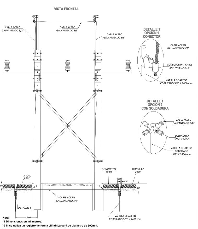
\*3 Se acepta cualquier tipo de conector, PAT cable varilla, que esté certificado y garantice la compatibilidad galvánica.
